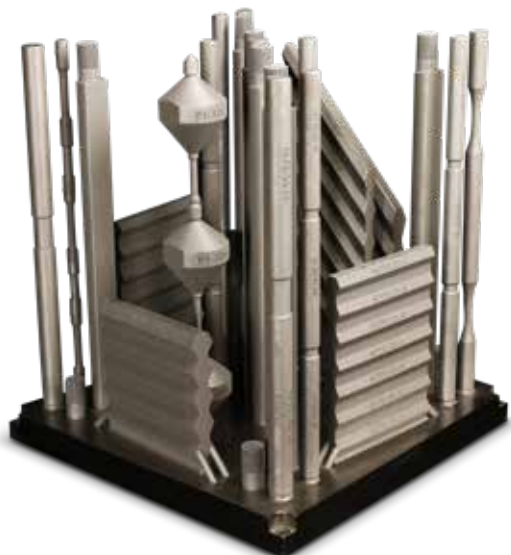
機械特性試験用ビルドプレート。
