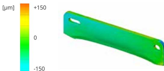
**Alta precisão** após a remoção do suporte e jateamento de areia, conforme medido por uma varredura 3D.
