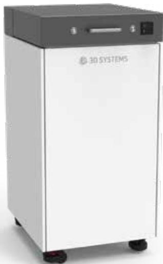
16 個の紫外線ランプがユニット内の 4 つの壁面に配置されているため、Figure 4 UV Cure Unit 350 は効率的で均一な硬化を実現します。機器内では、ビルドプラットフォームで部品を硬化でき、また複数の部品を同時に硬化できるよう複数の棚があり、高さが最大で 346 mm の Figure 4 Modular 部品に最適化しています。
