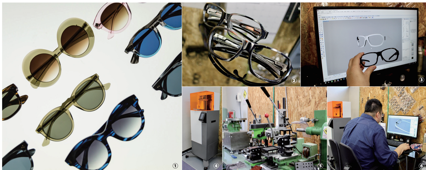
①企画開発商品の一例 ② Figure 4 で出力したプロトタイプは実物同様に組立てて折り畳むことができる ③ Rhinoceros の 3Dmodel と出力したプロトを比較 ④ Figure 4 の設置状況 ⑤ NC 旋盤などの各種加工機類を備えたミニ工場スペース ⑥ Figure 4 Standalone はコンパクトなので置く場所を選ばない
