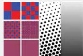
El fusionado o impresión de medio tono produce un efecto de tono continuo a una distancia de visualización suficiente y forma gradientes
