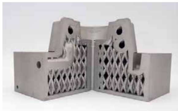
内部格子構造を適用すると、この部品の最終質量が大幅に減少しました
