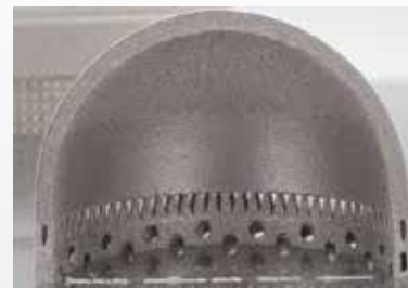
サポートなしでプリントされた 直径 15 mm のドーム
