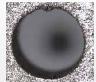
水平に造形された穴の例
